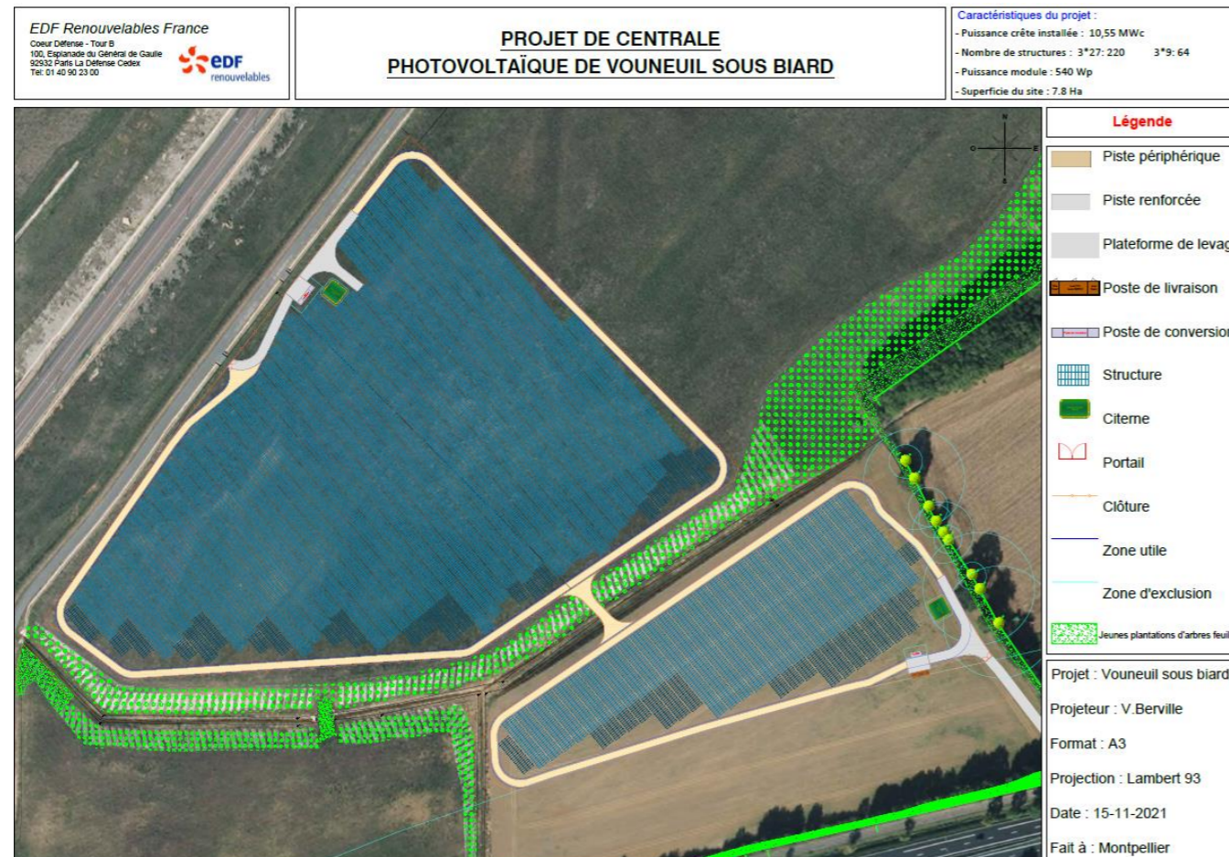
Figure 9 : Variante d'implantation retenue (Source : EDF Renouvelables)
